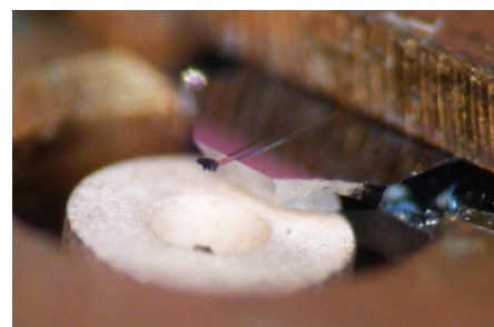
図 2. カンチレバーを用いた力検出 THz ESR のセットアップ. カンチレバーの長さは約 200 \mu\text{m} 程度で、先端にある黒いものが
